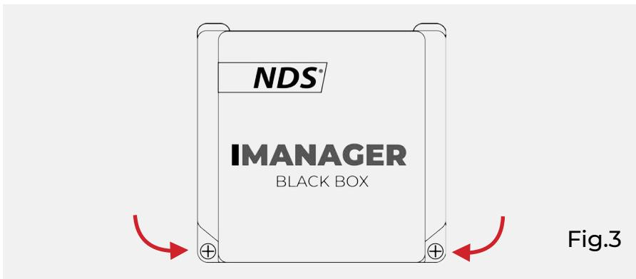
4. Coloca **IMANAGER** en el soporte elegido. Fija el dispositivo con los ojalos visibles en el interior del cuerpo con los tornillos suministrados o equivalentes (Fig.4).
