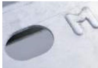
AL-KO-Chassis mit der »M«-Prägung am Längsrahmen (EA ab Mj2010 / TA ab Mj. 2015) verfügen serienmäßig über Aufnahmebohrungen für das MAMMUT-System.
