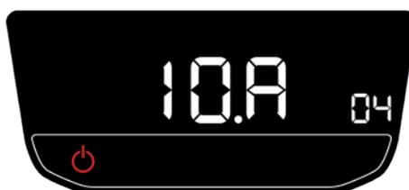
Transcurridos unos segundos, entrará en el modo de configuración inicial permitiendo seleccionar desde el panel de control el tipo de batería del que dispone el vehículo y a la que está conectada la unidad, seleccionando entre batería de plomo (Pb) o batería de litio (Li). Seleccione la opción deseada con los botones de incremento o reducción del panel de control o del mando a distancia y confirme esta opción con el botón ON/OFF de Encendido / Apagado del enfriador.
