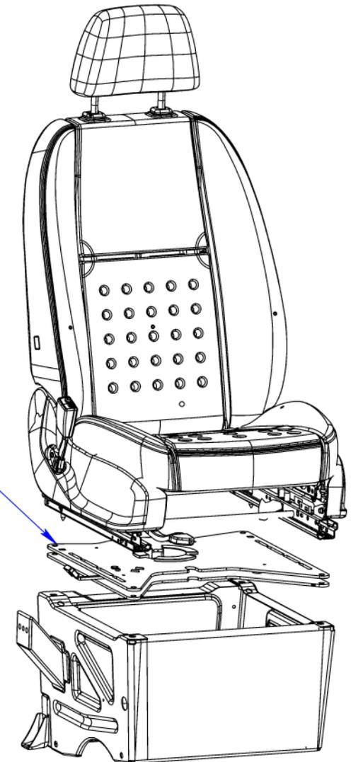
Décrocher le bloc connecteur pour le refixer au centre du siège
