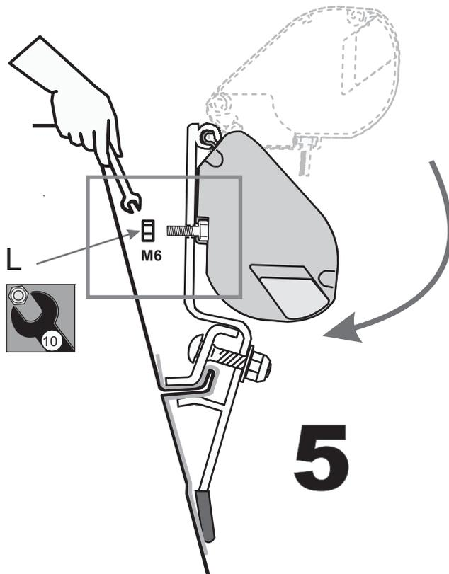
DE **ACHTUNG** Regelmäßig die Befestigung der Halterungen kontrollieren. Achten Sie vor allem nach dem ersten Sicherstellen darauf, dass sich die Haltebügel nicht verschoben haben.
